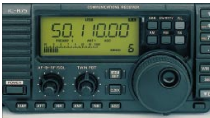
Bild 5: Diese Detailsicht der Frontpartie läßt insbesondere das sehr exakt anzeigende S-Meter erkennen, welches eine Spitzenwertanzeige („Peak Hold“) aufweist.
